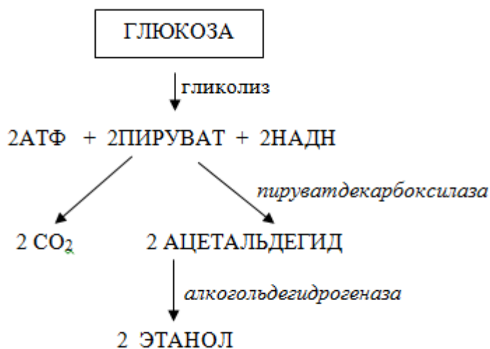
Рисунок 50 – Схема спиртового брожения у дрожжей
