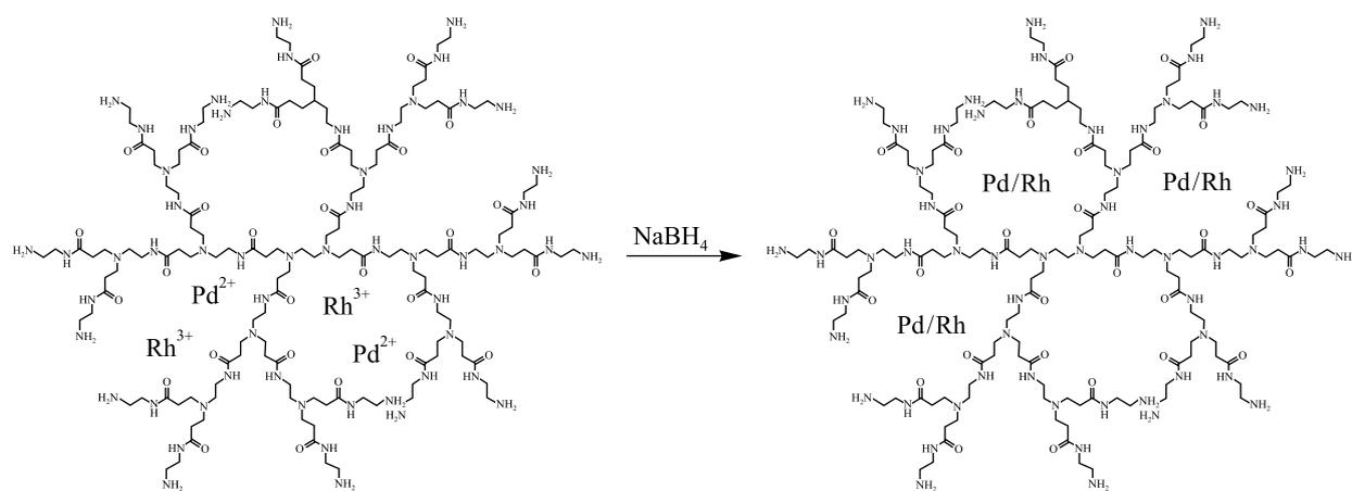
Рис. 11. Схема восстановления инкапсулированных катионов благородных металлов
