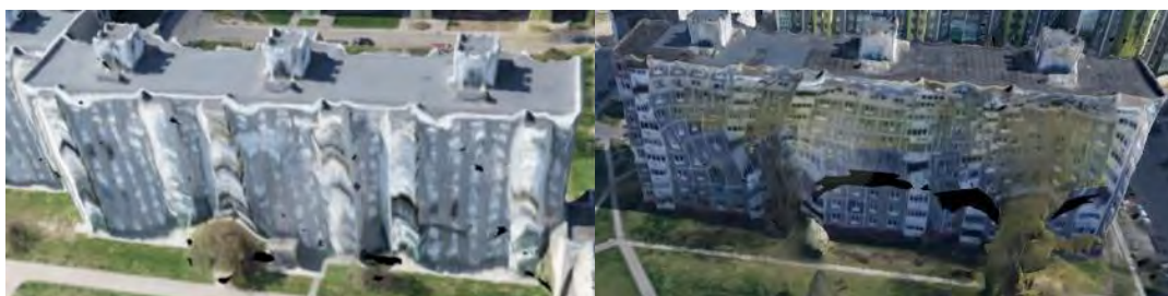
Рис. 2. Примеры дефектов фотограмметрической модели
