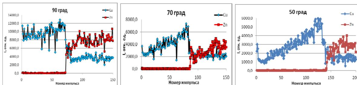
Рис. 1. Зависимость интенсивности линий Cu I (510,554 нм) и Zn I (481,053 нм) от количества импульсов и угла
