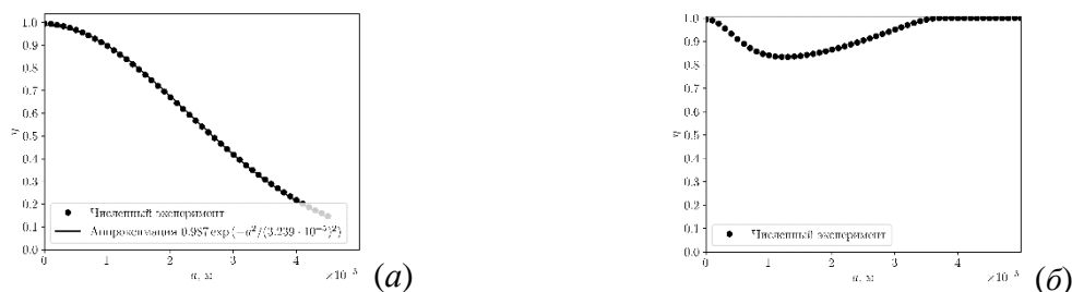
Рис. 3. Зависимость эффективности преобразования в коническую компоненту спектра от величины скругления аксикона a для аксиконов I (а) и II (б)
