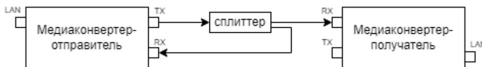
Рис. 3. Схема подключения медиаконвертеров со сплиттером
