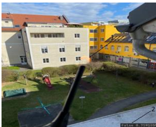
Рис. 1. Работа алгоритма в условиях открытой местности (1 – пламя, 2 – точность распознавания пламени алгоритмом)
