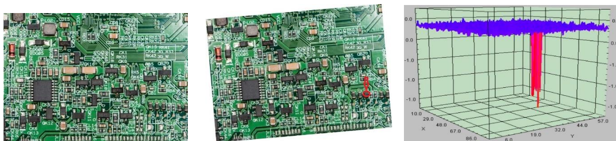
Алгоритм работы системы, а – изображение исходной платы, б – изображение платы с дефектом, в – карта корреляции
