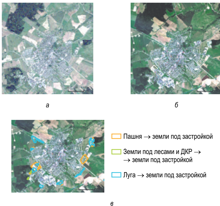
Рис. 4.10. Пример обнаружения прироста земель под застройкой вблизи Новогрудка: а – снимок от 16 сентября 2006 г.; б – снимок от 26 августа 2016 г.; в – обнаруженные трансформации
