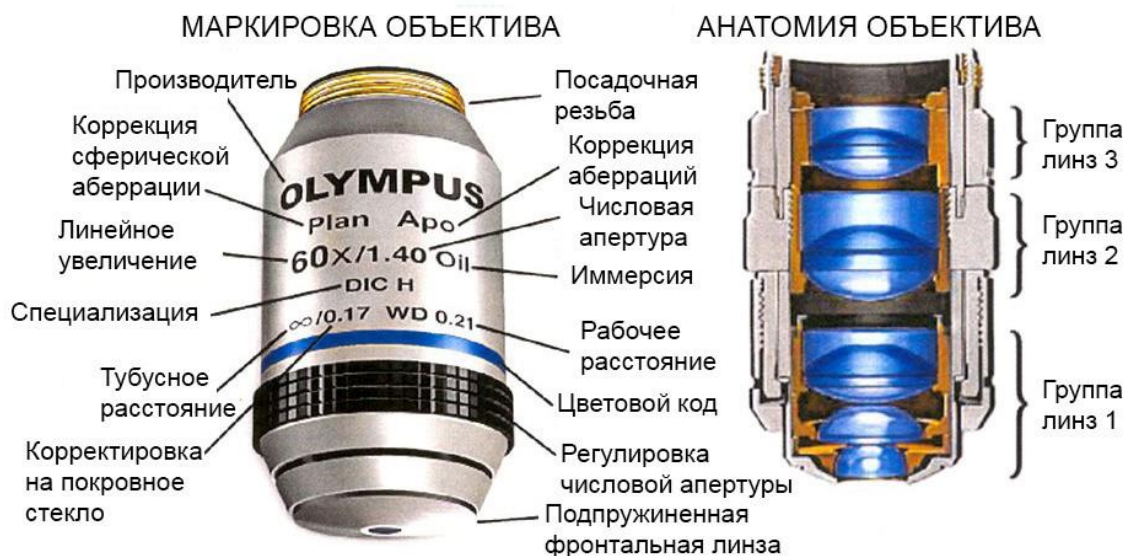
Рисунок 2 – Устройство объектива флуоресцентного микроскопа
