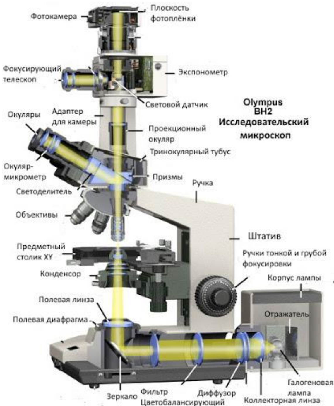
Рисунок 1 – Устройство флуоресцентного микроскопа
