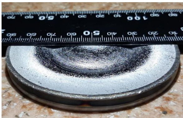
Рис. 1. Фотография распыленной мишени из титана диаметром 80 мм на разработанной МРС
