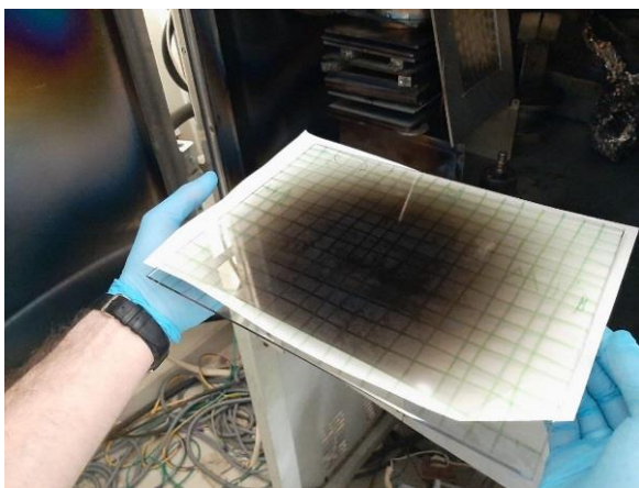
Рис. 4. Фотография полученного покрытия на стеклянной подложке при расстоянии мишень-подложка 250 мм
