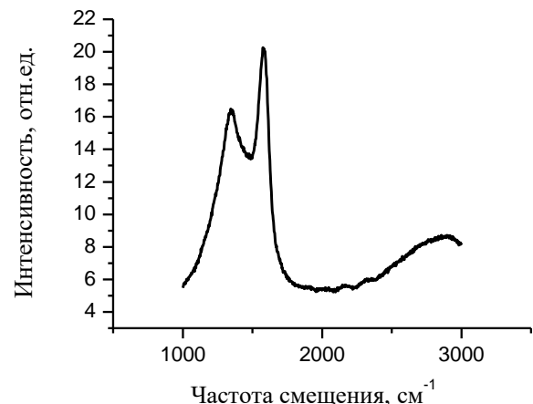
Рис. 1. Спектр комбинационного рассеяния покрытий пиролитического углерода, легированного бором
