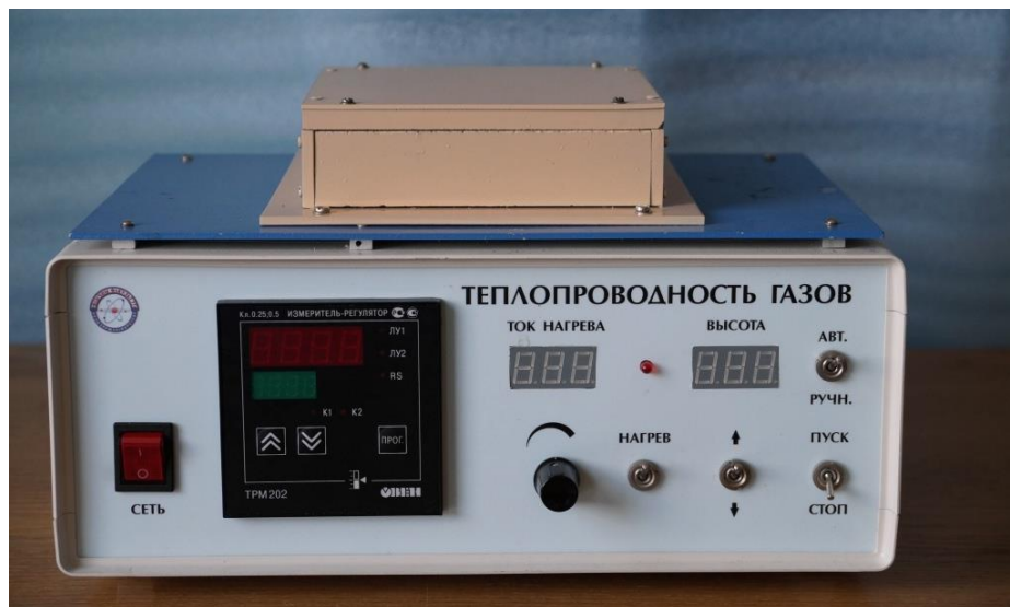
Рисунок 2 – Внешний вид установки для исследования теплопроводности газов
