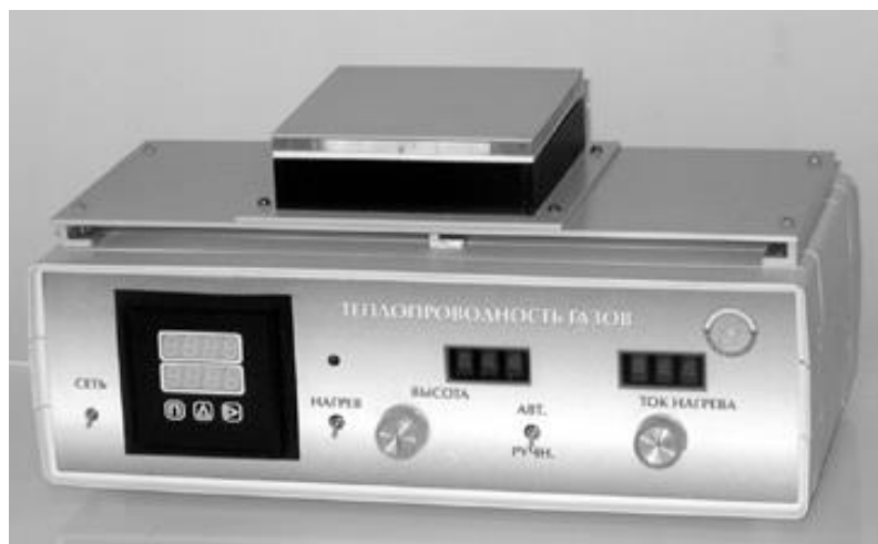
Рисунок 2 – Внешний вид установки для исследования теплопроводности газов
