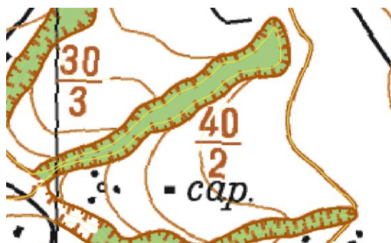
Рис. 7.- Горизонтالي пересекающие овраги и промоины
