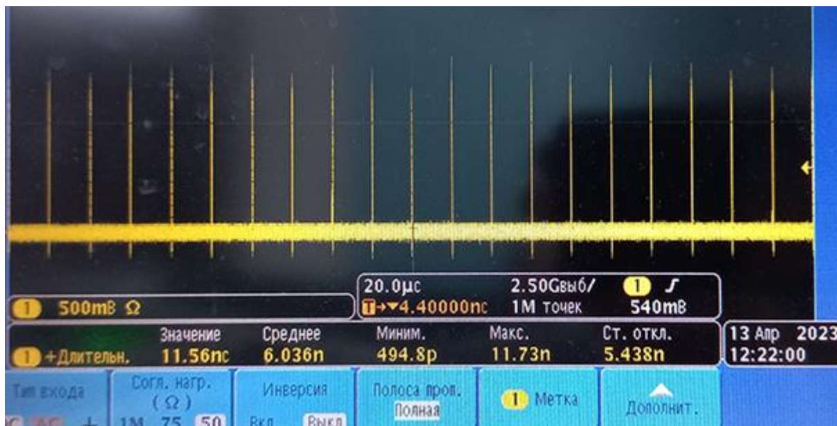
Рисунок 2 – Цуг ультракоротких импульсов на выходе регенеративного усилителя (частота 100 кГц)
