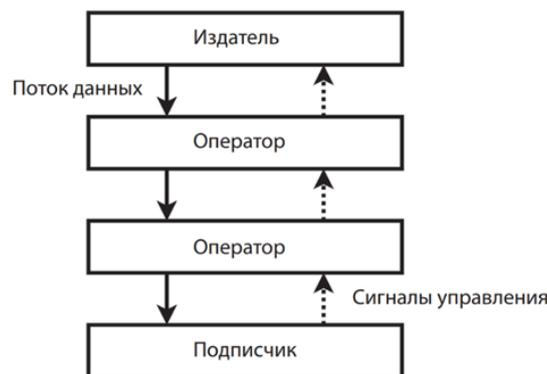
Рис. 2. Передача данных и сигналов управления в реактивном потоке
