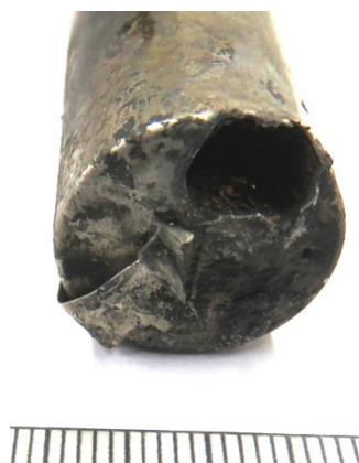
Рис. 9. Вид прожига в элементе питания типоразмера «18650»
