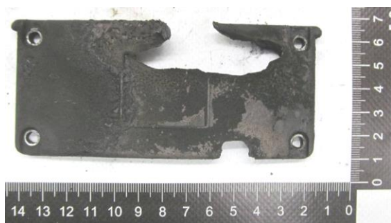
Рис. 4. Вид прожига в торцевой части деки
