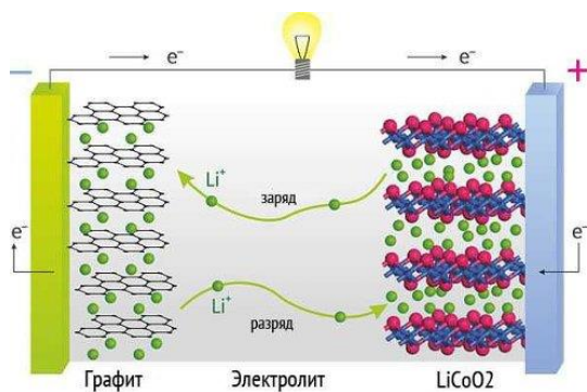
Рис. 2. Схема заряда-разряда литий-ионного аккумулятора
