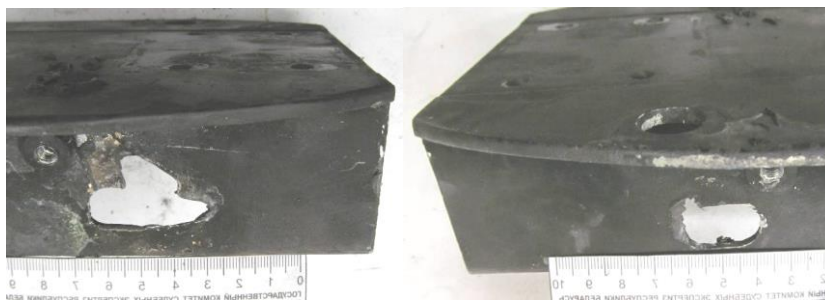
Рис. 5, 6. Вид прожигов в боковых стенках деки
