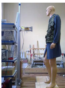
Рис. 3. Макет микроволнового сканера с подвижной платформой для горизонтального перемещения манекена
