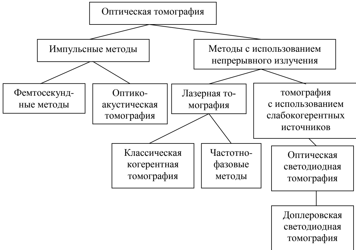
Рис. 1. Классификация методов оптической томографии
