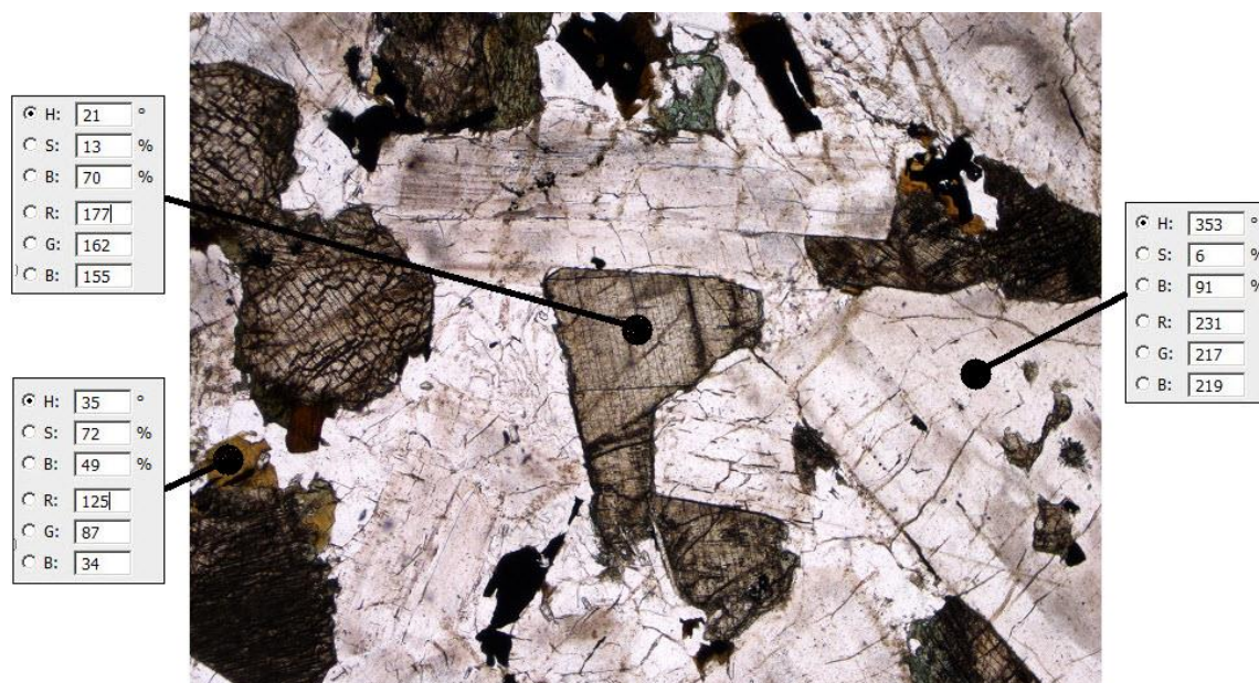
Рисунок 2 – Параметры цвета минералов в шлифе габбро, без анализатора Размер поля зрения 3,12 мм.
