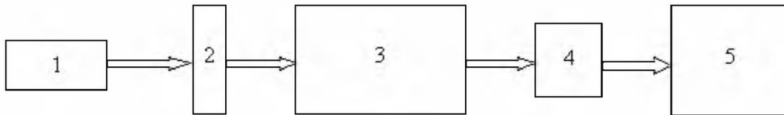
Рис. 2. Функциональная схема установки для исследования спектров люминесценции (1) лазерный диод, подключенный к источнику постоянного тока через ограничивающий резистор, (2) пленочный поляризатор ИК-диапазона, (3) монохроматор МДР-23, (4) фотоэлектрический германиевый приемник, охлаждаемый жидким азотом, (5) устройство обработки и вывода информации, включающее широкополосный усилитель, осциллограф и компьютер с программой для отображения спектра на экране
