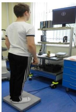
**Рисунок – Стаболоанализатор компьютерный «Стабилан – 01» с биологической обратной связью**
