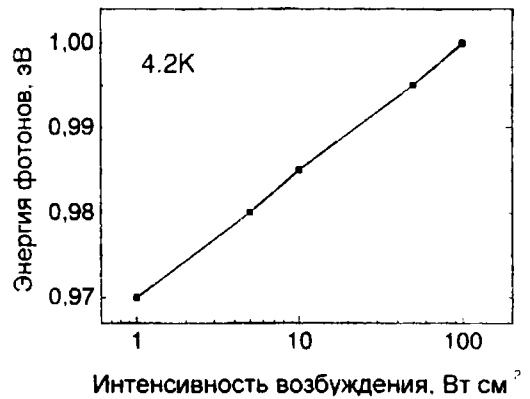
Рис.3. Зависимость спектрального положения близкраевой полосы от уровня возбуждения.
