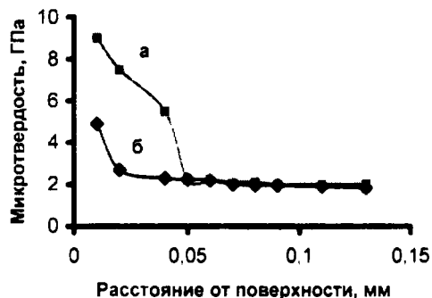
Рис. 1. Микротвердость железа после электроискрового легирования с предварительным азотированием: а – титановый анод; б – хромовый анод
