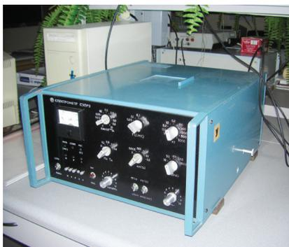
Малогобаритный специализированный анализатор электронного парамагнитного резонанса «Минск-22М»
