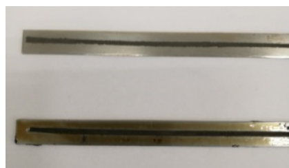
Рисунок 2. Схема образца пленочного нагревательного элемента (а) и окончательный вид пластин с пленочным нагревательным элементом (б)
