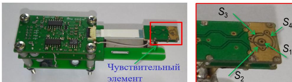
Рисунок 2. Комбинированный измерительный преобразователь для режимов SKP, SPV и JPV
