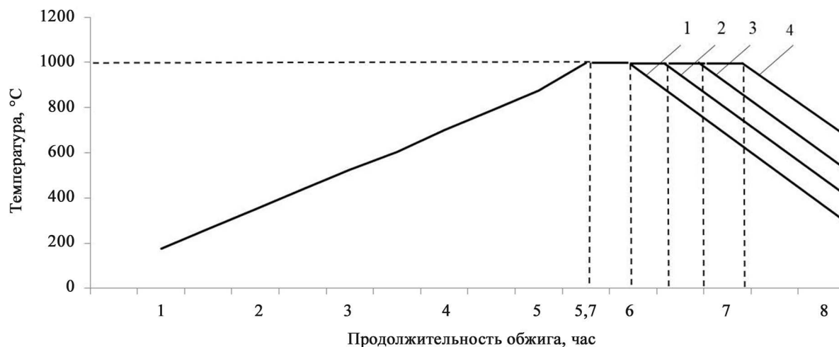
Рис. 8. Графики режимов обжига
