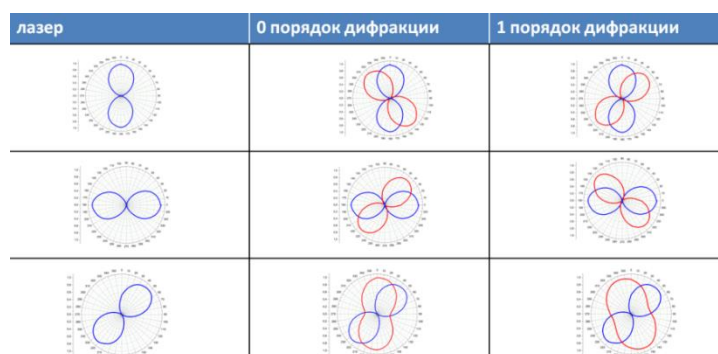
Рис.3. Зависимость выходной поляризации от падающей для ячейки с бинарной ориентацией «твист/планар»
