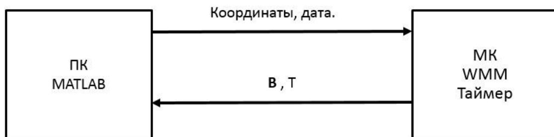
Рис. 3 Схема тестирования модели WMM реализованной на МК
