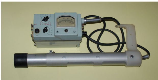
Fig. 2 The SRP-68-01 survey meter
