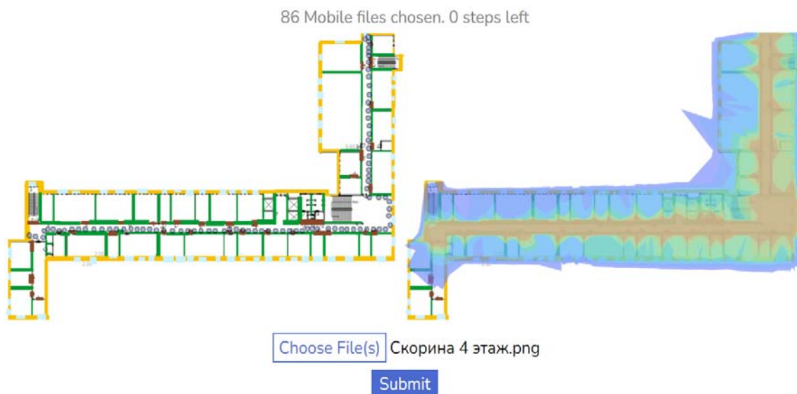
Рисунок – Выполнение отрисовки на базе данных Acrylic Wi-Fi Heatmaps
