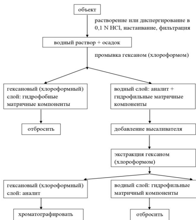
Рисунок 1. – Схема экстракционной пробоподготовки при газохроматографическом определении органических оснований
