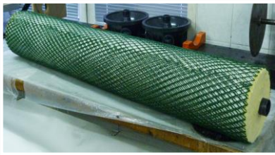
Рисунок 3 – Ионообменный фильтр на основе нетканого анионообменного полотна ФИБАН.
