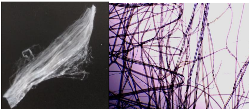
Рисунок 2. Макро и микроизображения матов из поли-L-лактидного волокна
