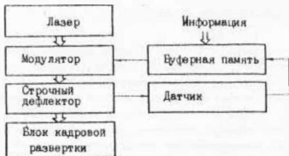
Рис. 1. Структурная схема лазерного устройства вывода информации
