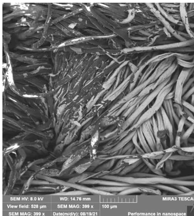
Рисунок 2 – Структура ткани после лазерного воздействия (на краю зоны воздействия): а) вложенная энергия 2 Дж, время воздействия 2 с
