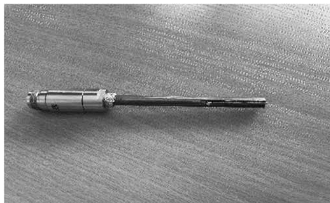
Рисунок 2 – Внешний вид коаксиального датчика для контроля диэлектрических свойств машинного масла.
