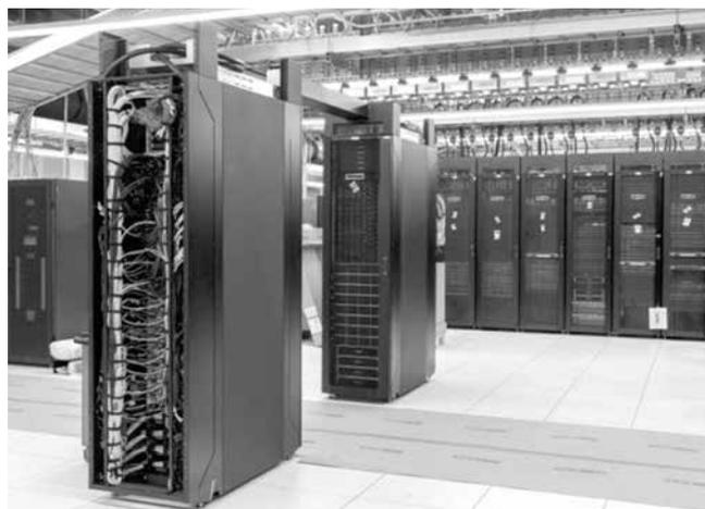
Пиковое быстродействие Frontier, как ожидается, окажется на отметке 1,5 Эфлопс. Энергопотребление системы – приблизительно 29 МВт, или 19,33 МВт в расчёте на один Эфлопс, что делает её самой энергоэффективной системой подобного класса на текущий момент. Для охлаждения машины потребовалось почти 500 тыс. л теплоносителя и четыре насосных станции мощностью 350 л.с. каждая.
