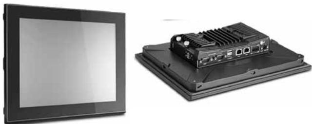
**MPC-2070** – Безвентиляторный панельный компьютер с 7" 1000 нит, емкостный сенсорный экран, процессор Intel Atom E3826, 4Гб DDR3, 32Гб CFast, отсек для SD карт, 2xCOM, 2xUSB, 2xLAN, DIO, питание 12/24 В DC, рабочая температура от -40°C до +70°C.
