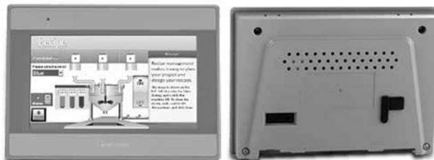
**MT8071iE** – Панель оператора HMI, 7" TFT, 600 МГц, 128 Мб RAM, 128 Мб диск, сенсорный экран, 1xLAN, 1xUSB host, 1xRS-232/485, 1xRS-485, 1xRS-232, NEMA4/IP65 по передней панели, ATEX Zone 2/22 Category 3 G/D, пластиковый корпус. Программируется посредством бесплатной среды Easy Builder PRO
