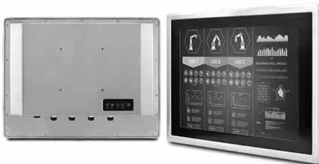
**R15L600-65EX** – Промышленный монитор 15" TFT LCD, разрешение 1024x768, яркость 550 нит, резистивный сенсорный экран (USB), VGA, питание 9...36В DC, стальной корпус, защита IP65
