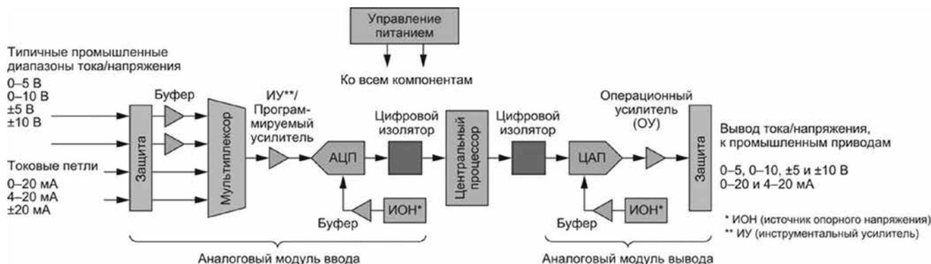
Рисунок 1 – Типичная сигнальная цепочка ПЛК
