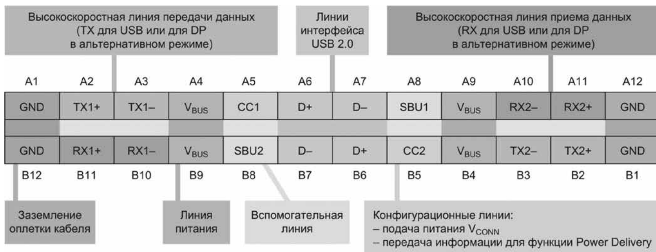
Рисунок 1 – Назначение выводов 24-контактного разъема USB Type-C
