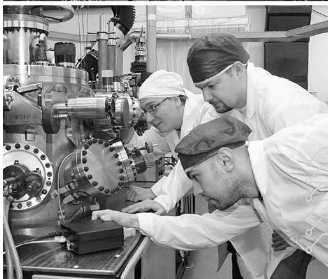
Рисунок 6 – Установка для молекулярно-лучевой эпитаксии (МЛЭ – напыление различных материалов на плоские подложки в условиях сверхвысокого вакуума) была изготовлена и работает в ИФП им. А. В. Ржанова СО РАН
