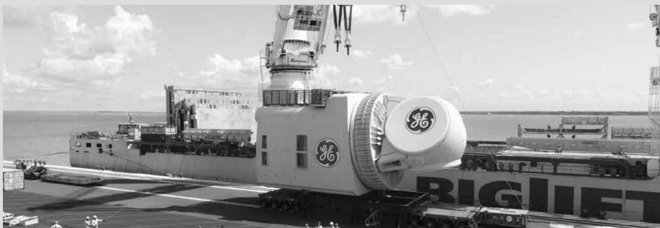
Компания General Electric стоит за самой большой в мире морской ветряной турбиной Haliade-X. Установленный недалеко от Роттердама (Нидерланды), этот прототип мощностью 12 МВт получил обновление. Ветряная турбина высотой 248 метров теперь имеет мощность 13 МВт, или на 8% больше. По данным General Electric, турбина побила собственный рекорд по производству электроэнергии – 312 МВт/ч за один день по сравнению с 288 МВт/ч ранее.
