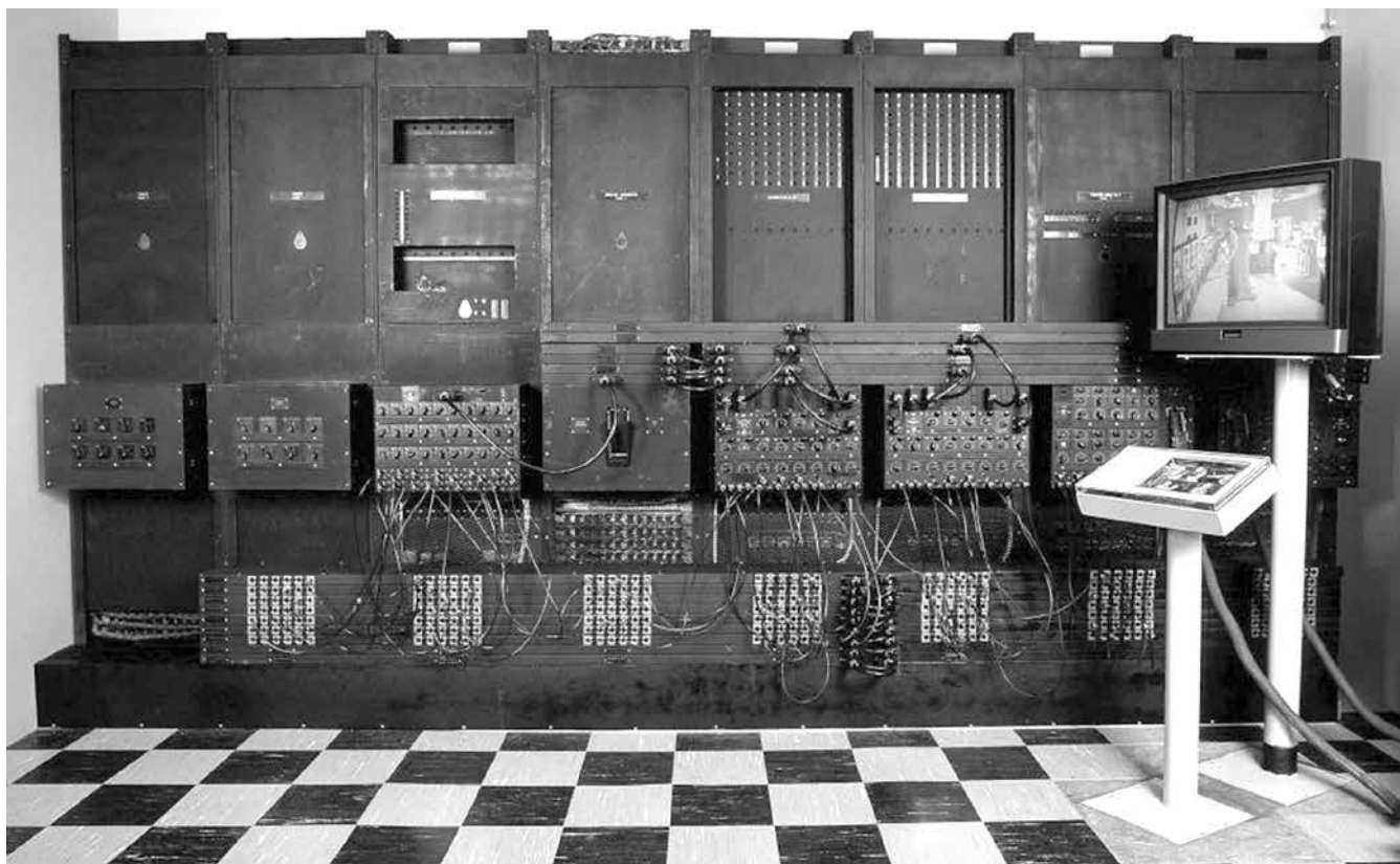
Рисунок 1 – Первая универсальная вычислительная машина ENIAC, построенная в 1946 году, весила 27 тонн и использовала в качестве элементной базы вакуумные лампы
