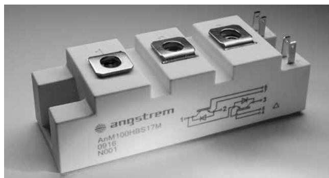
Рисунок 14 – Мощный IGBT-модуль производства «Ангстрема». Обратите внимание, что компания создает не только сами приборы, но и конечную продукцию на их основе
