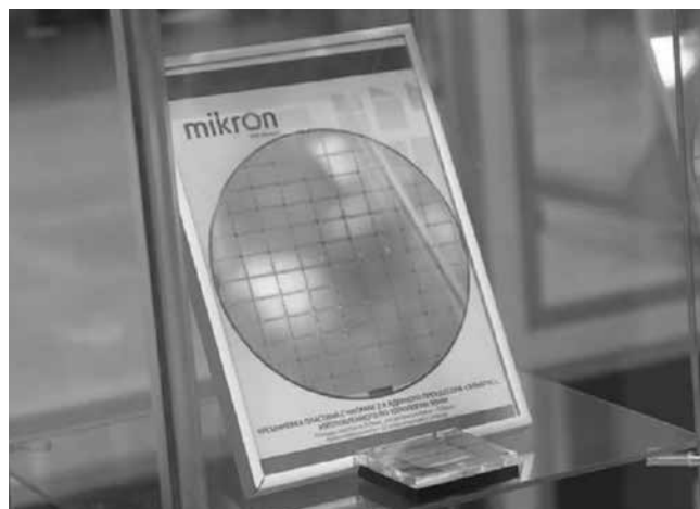
Рисунок 12 – Пластина с изготовленными по нормам 90 нм процессорами «Эльбрус», стоящая в фойе АО «НИИМЭ»
