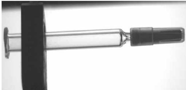
*Рисунок 4 – Изображение было получено с помощью устройства с зарядовой связью размером 640×480. Оно используется при осмотре стеклянных шприцев с пластиковым колпачком, а целью применения является определение того, достаточно ли плотно надет колпачок*
