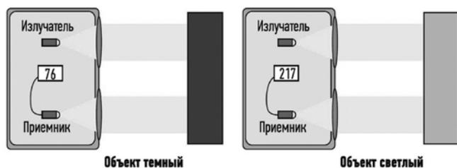
Рисунок 2 – Аналоговый фотоэлектрический датчик, работающий на отражение, может обеспечить необходимую шкалу измерений уровня отражения света от объекта
