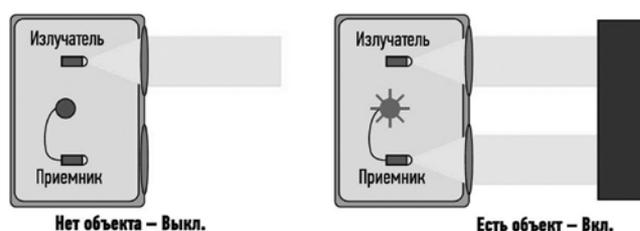
Рисунок 1 – Дискретный фотоэлектрический датчик, работающий на отражение, сообщает, измерено ли заданное значение (характеристика), идентифицирующее объект
