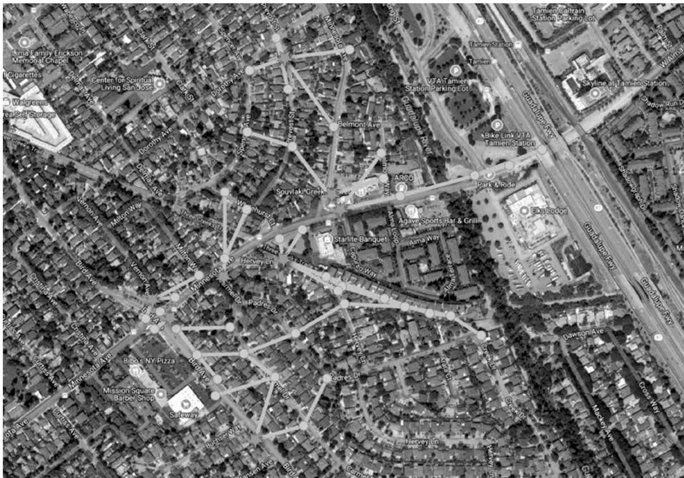
Рисунок 4 – Фрагмент карты Сан-Хосе в проекте Terragraph-подобной сети AT&T. Точки – подключения к оптике. Источник: Digital Twin Sim
