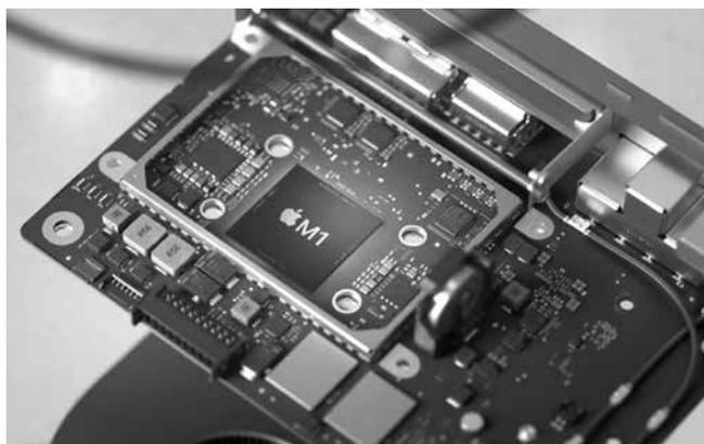
Apple M1 представляет собой 5-нм систему на чипе (SoC) из 16 млрд транзисторов. В ней уместилось восемь ядер CPU, восемь графических ядер, а также 16 ядерный вычислительный нейроблок, на лад того, что есть в мобильных процессорах Apple. Часть CPU состоит из двух кластеров: четыре мощных ядра и четыре энергоэффективных. Графический процессор включает 128 исполнительных блоков, а его производительность достигает 2,6 Тфлопс, что весьма немало.
