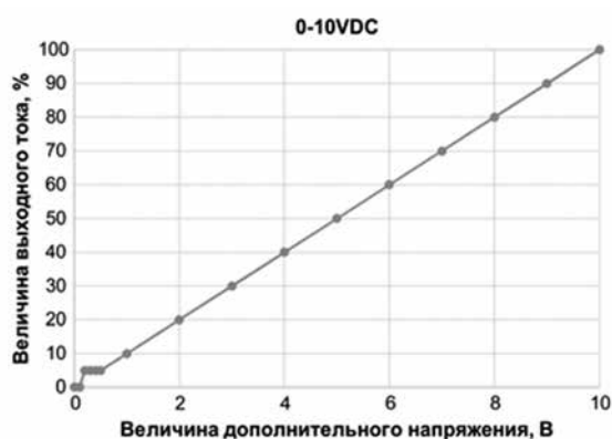
Рисунок 3 – Управление яркостью с помощью постоянного напряжения 0...10 В
