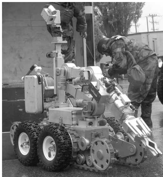
Рисунок 5 – Компания Northrop Grumman Remotec располагает широкой линейкой роботов для различных приложений: для военных, обезвреживания взрывоопасных предметов (ОВП), опасных веществ и обеспечения правопорядка. Семейство названо ANDROS, оно включает модели HD-1, F6A, Mk V-A1, Mini-ANDROS и WOLVERINE. На фото взрывотехники за работой с моделью F6A
