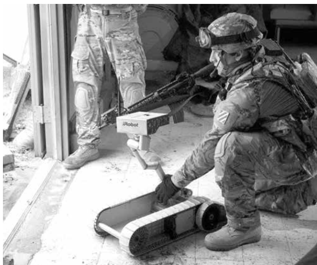
Рисунок 4 – SUGV от iRobot может переносить и управлять одним солдатом
