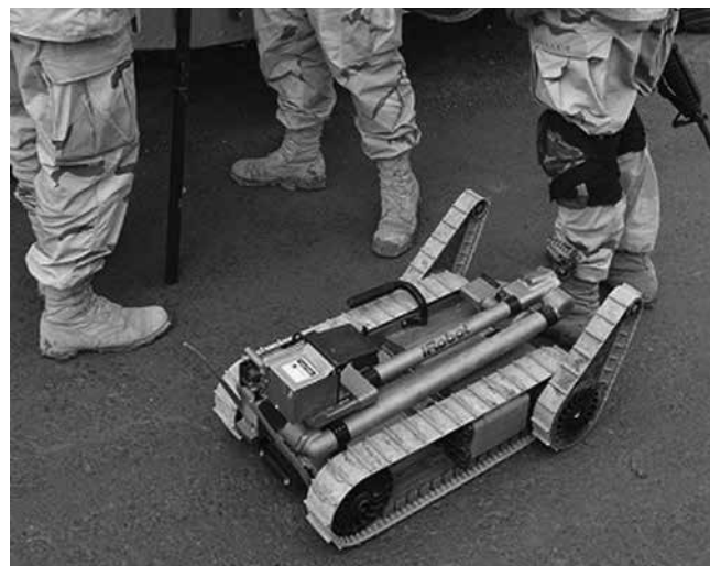
Рисунок 11 – PackBot от iRobot готов для задач противодействия самодельным взрывным устройствам в Ираке. Компания поставила более 2525 НМР серии PackBot американским ВС шестью партиями и плюс несколько сотен комплектов обезвреживания взрывоопасных предметов
