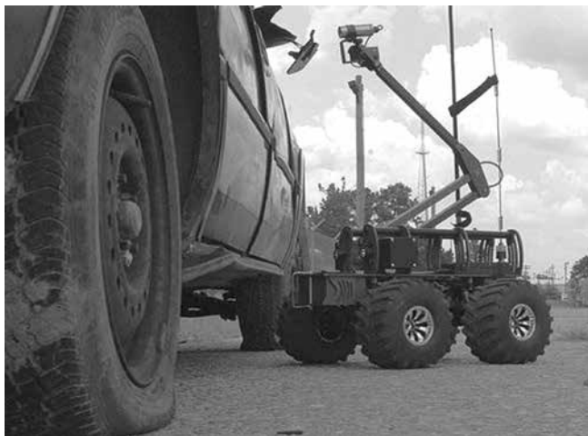
Рисунок 8 – MARCbot IV выдвигает свою камеру для поиска подозрительных СВУ
