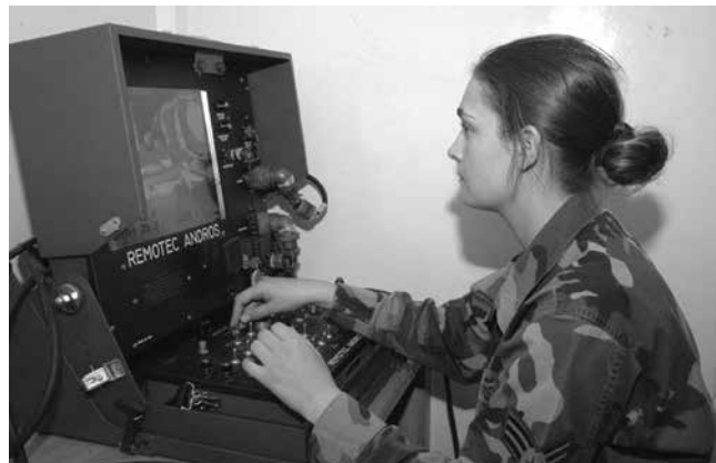
Рисунок 9,10 – Управление современным НМР требует персонального компьютера или, по меньшей мере, ноутбука (на фото сверху рабочее место управления для Remotec ANDROS), но для перспективных малых НМР он будет значительно уменьшен до носимого набора, состоящего из небольшого пульта и наплывного дисплея
