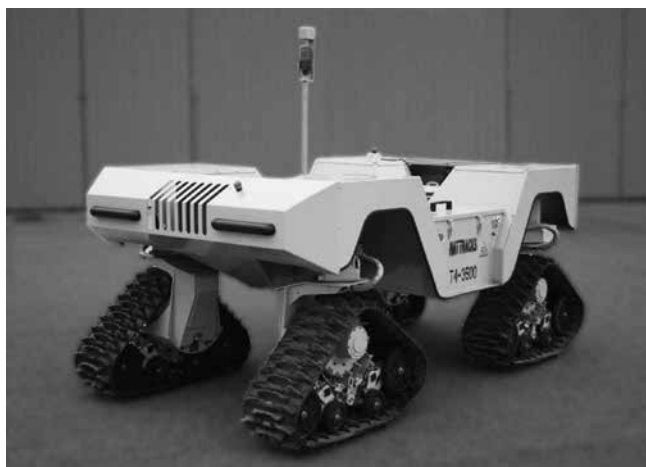
Рисунок 3 – В роботе MATTRACKS T4-3500 используется гусеничная технология, которая обеспечивает подвижность и хорошее сцепление в грязи, песке, снегу, болоте и тундре. TARDEC работал с компанией Mattracks над проектом гусеничного HMP в части разработки шасси и электропривода
