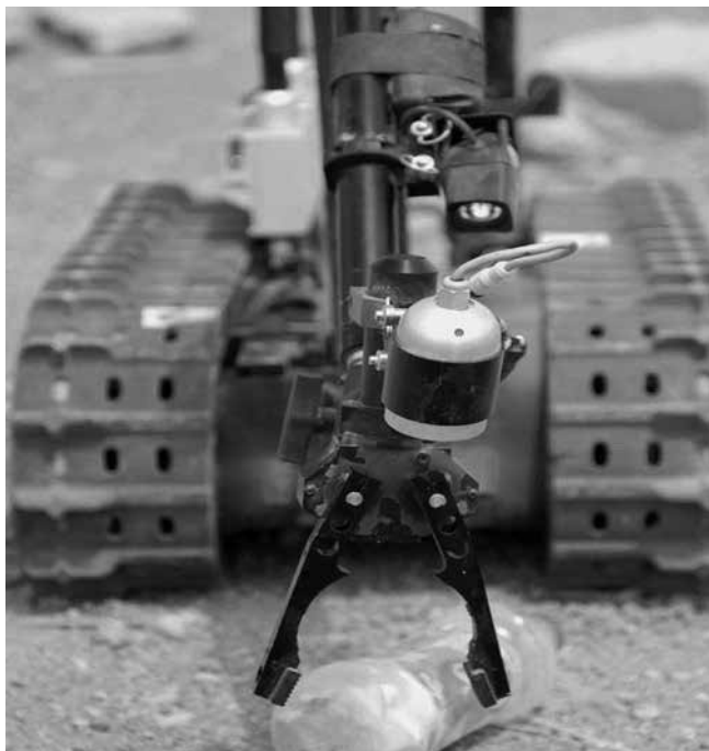
Рисунок 7 – Робот TALON, управляемый рядовым 17-го инженерного полка иракской армии, поднимает пустую бутылку своим захватом во время совместных учений в южном Багдаде. TALON был разработан компанией Foster-Miller (часть QinetiQ North America) и широко и успешно использовался в операциях по обезвреживанию взрывоопасных предметов в Ираке и Афганистане
