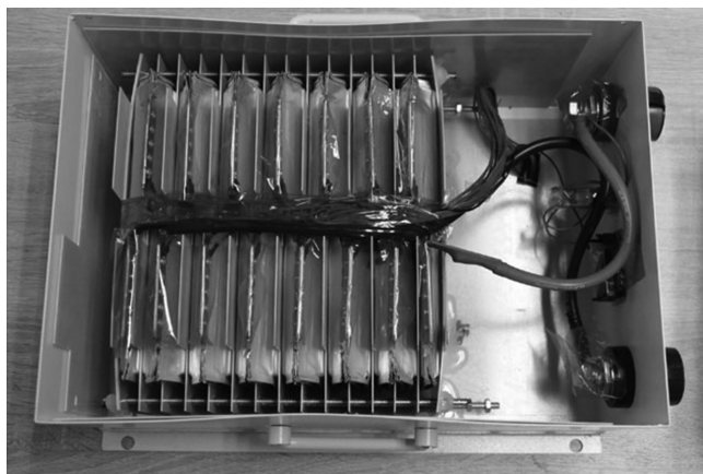
Рисунок 3 – Внутреннее устройство батареи
