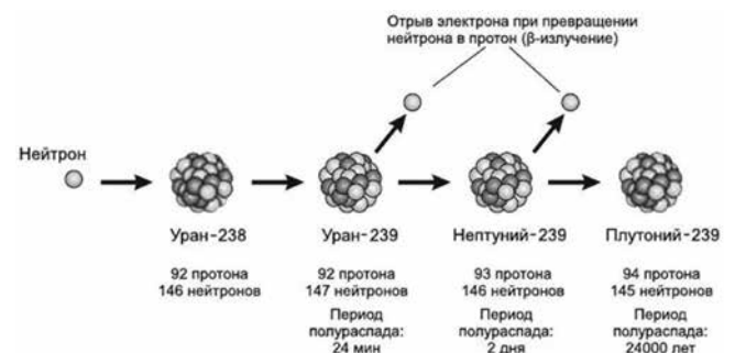
Рисунок 2 – Схема трансмутации Урана 238 в Плутоний 239
