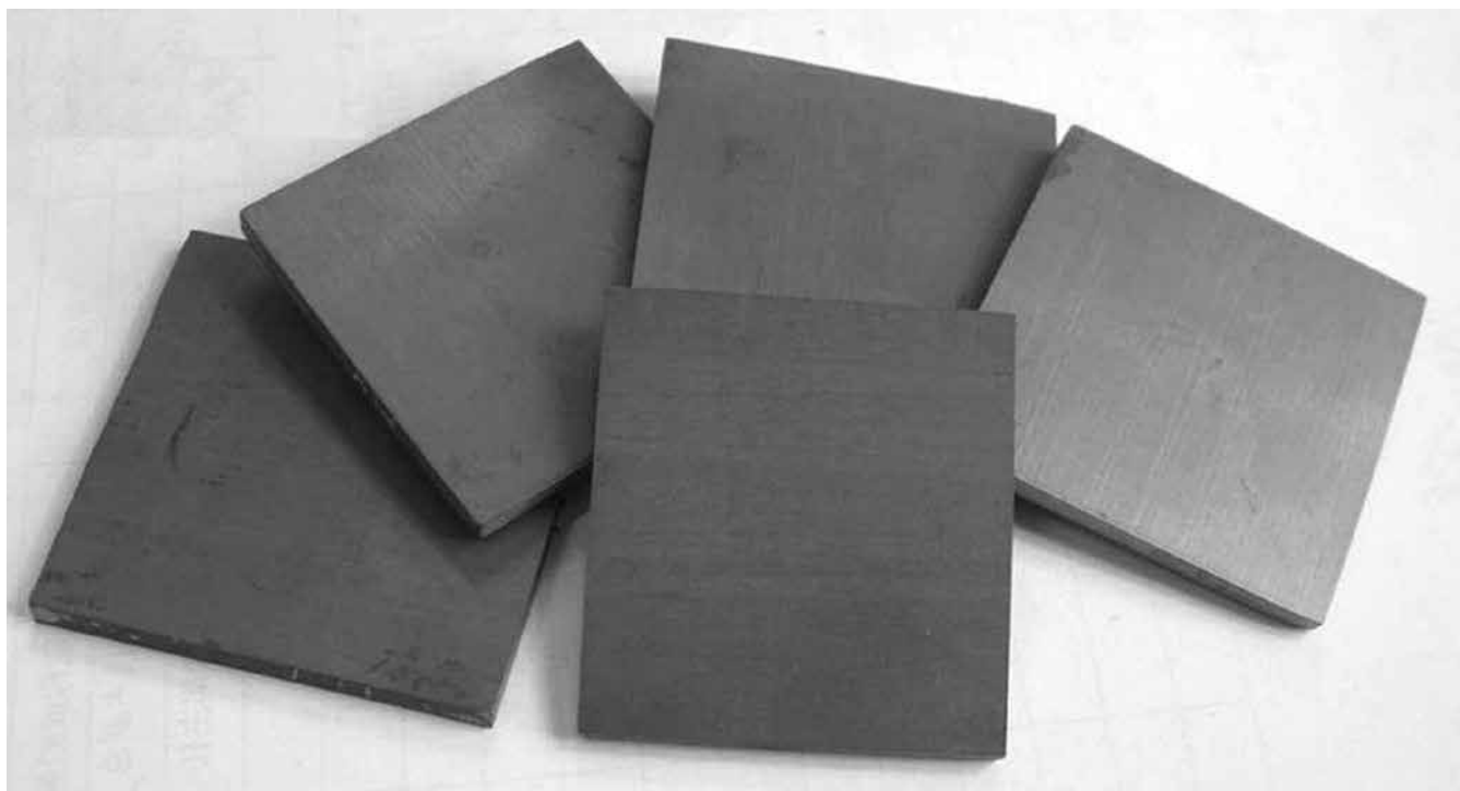
Рисунок 1 – Эти невзрачные пластины сделаны из карбида кремния
