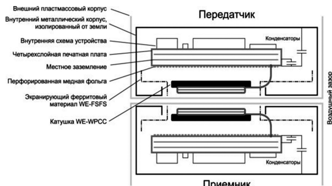
Рисунок 3 – Пример решения, когда из-за ограничения по току утечки или ввиду специфики устройства нельзя использовать Y конденсатор
