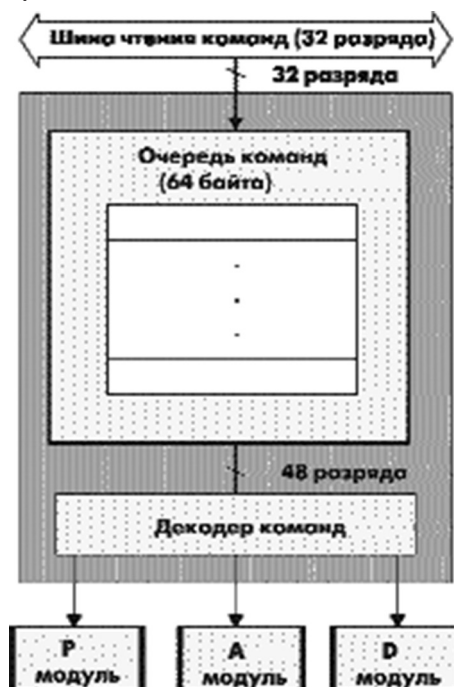
Рисунок 4 – Структура модуля декодера команд (I-модуль)
