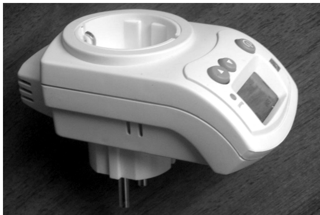
Рисунок 4 – Настройка диапазона желаемых температур происходит с помощью специальных кнопок, размещенных на лицевой части устройства
