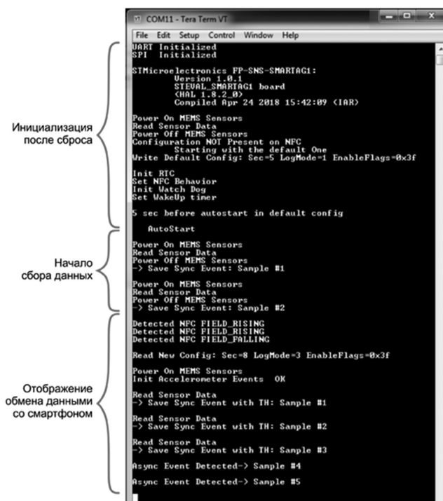
Рисунок 11 – Отображение обмена со смартфоном на терминале последовательного порта
