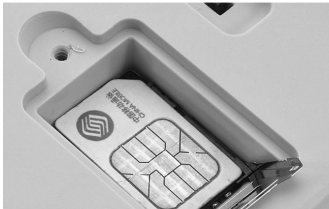
Рисунок 7 – В устройствах, контролируемых по sms, с обратной стороны есть специальное гнездо для установки sim-карты
