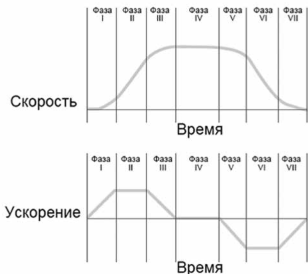
Рис. 3 – Профиль S-кривой позволяет уменьшить рывки (изменения ускорения) в каждой переходной точке траектории.
