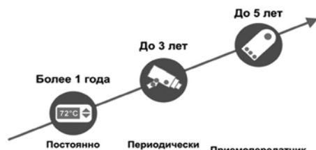
Рисунок 4 – Время автономной работы различных приложений на базе беспроводного микроконтроллера SimpleLink CC3220
