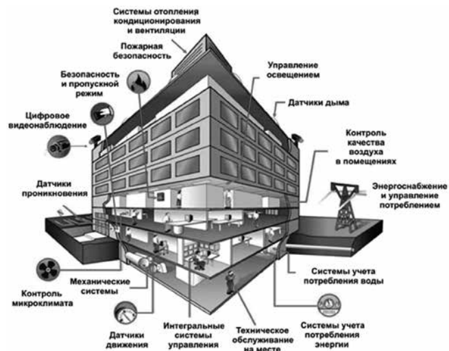
Рисунок 2 – Система автоматизации зданий
