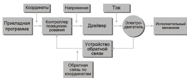
Рис. 1 – Базовая система управления позиционированием в робототехнике.
