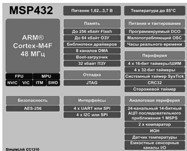
Рисунок 3 – Микроконтроллеры SimpleLink MSP432 с 14-битным АЦП
