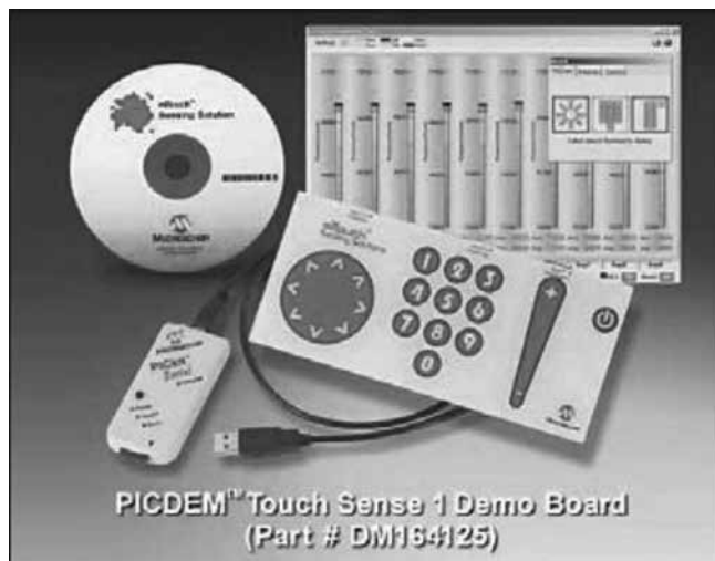
Рисунок 8 – Стартовый набор PICDEM Touch Sense 1 Development Kit
