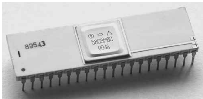
Рисунок 4 – Микропроцессор 580BM80, советский клон Intel 8080
